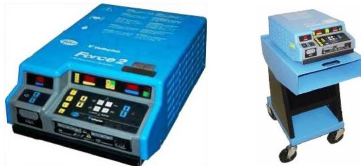
Realiza corte y coagulación monopolar y en salidas bipolares. Tiene alarmas sonoras y visuales, incluyendo el indicador de fallo REM™. El sistema REM™ (Monitoreo electrodo de retorno) es estándar y controla continuamente los niveles de impedancia del paciente. Si una falla en el contacto de los electrodos del paciente / retorno se
